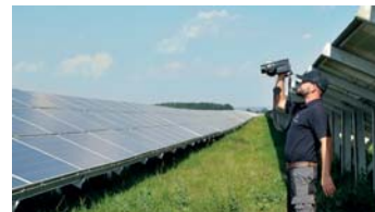
Ingenieur des PI-Berlin erstellt Thermografiebild
